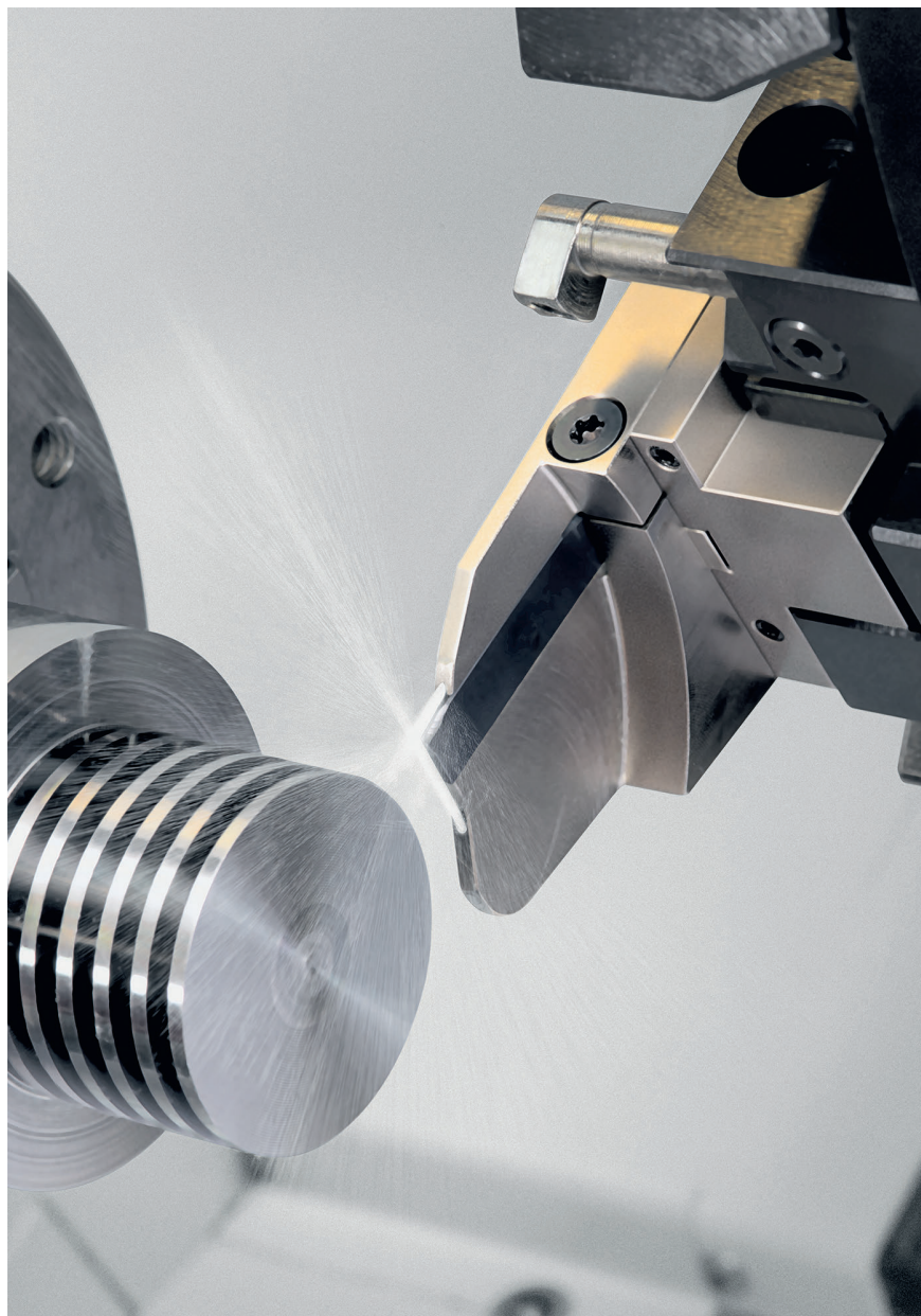
1 Mit einer Innenkühlung durch clever gestaltete, hochfeine Kanäle gelingt es innovativen Werkzeugherstellern wie Arno, den Kühlschmierstoff direkt in die Schneid- und damit in die Problemzone zu führen © Arno
